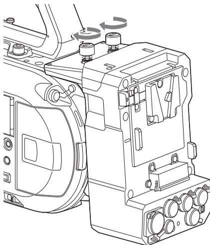
Крышку гнезда модуля расширения можно вставить в верхнюю часть модуля расширения.
