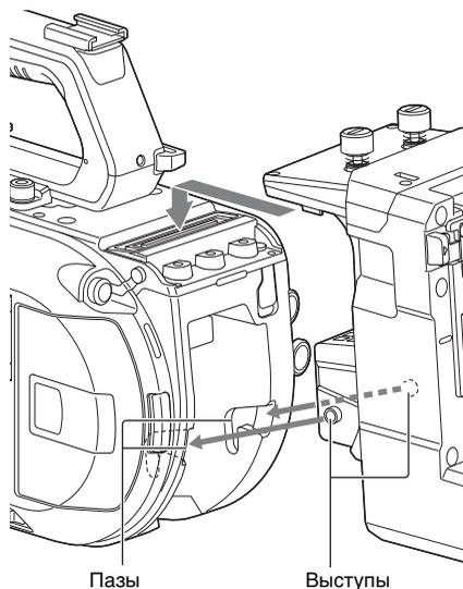
**4 Затяните два винта, расположенных на верхней части модуля XDCA-FS7, чтобы зафиксировать его.**
