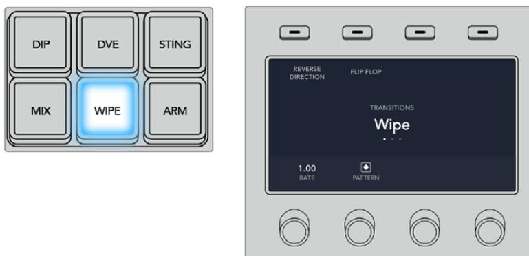
Нажмите кнопку на шине выбора, чтобы указать источник сигнала для границ вытеснения. Удерживая нажатой кнопку SHIFT, выберите дополнительный источник, такой как генераторы цвета или медиаплеер.
