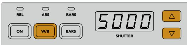
Чтобы установить баланс белого в градусах Кельвина, используйте кнопку W/B одновременно с одной из кнопок со стрелками рядом с индикатором SHUTTER
