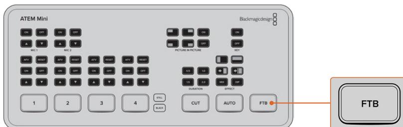
Чтобы выйти из затемнения, нажмите кнопку FTB еще раз. Полное затемнение является эффектным приемом, который можно использовать в самом начале и конце трансляции.
