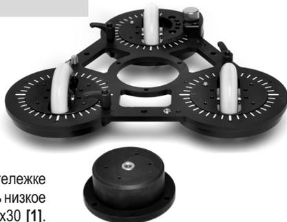
Что бы прикрепить высокую чашу AF-15 к мини-тележке Slide Kamera HSO-4 в первую необходимо отсоединить низкое основание, открутив с нижней стороны три винта М6х30 [1]. Далее с помощью тех же самых винтов на месте низкого основания прикрутить высокую чашу AF-15.
