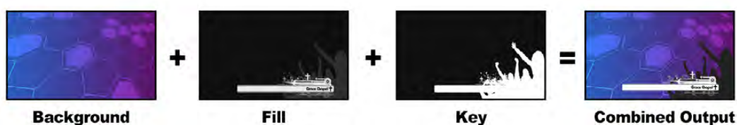
Совмещение фона, заполняющего и вырезающего сигналов при линейном кеинге
